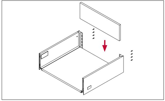
**ШАГ 2. Установка задней стенки.** Для фиксации мы рекомендуем использовать шурупы 3,5x16 – 4 шт. с головкой потай.
