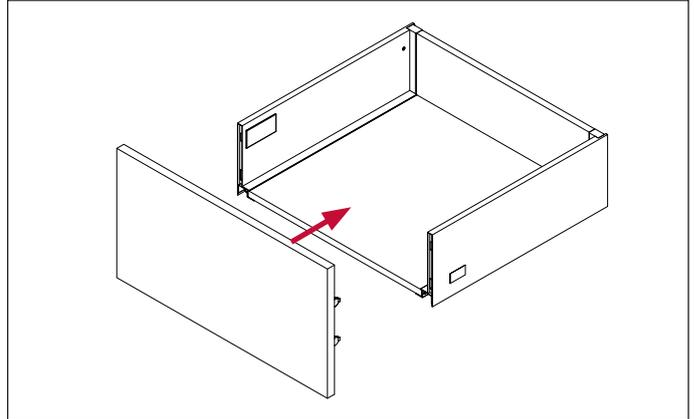
**ШАГ 4. Монтаж фасада на ящик.** Фасад защелкивается на боковинах с характерным щелчком.
