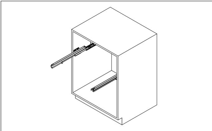
**ШАГ 5. Установка направляющих на каркас ящика.** Для фиксации направляющих на боковые стенки ящика мы рекомендуем использовать евроинты 6,3x13, также допустимо использование шурупов 4 x16 с головкой потай.
